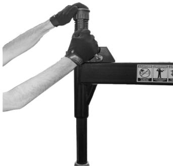
Tirez sur la poignée de verrouillage pour verrouiller l'arbre vertical en position. Une fois l'arbre verrouillé, la tête de montage/démontage se déplace vers le haut d'environ 1/8 po (3,175 mm) et en arrière 1/8 po (3,175 mm) du bord de la jante, offrant ainsi un jeu de fonctionnement.
